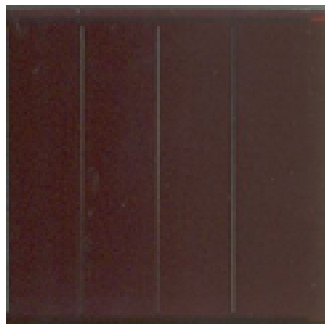
Figure I.11: La cellule au silicium amorphe [27]
