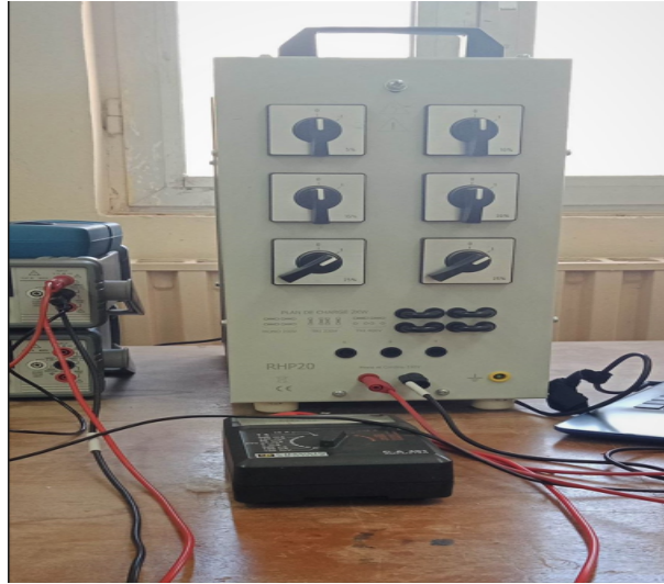
FIGURE II.10 – Charge résistive monophasé
