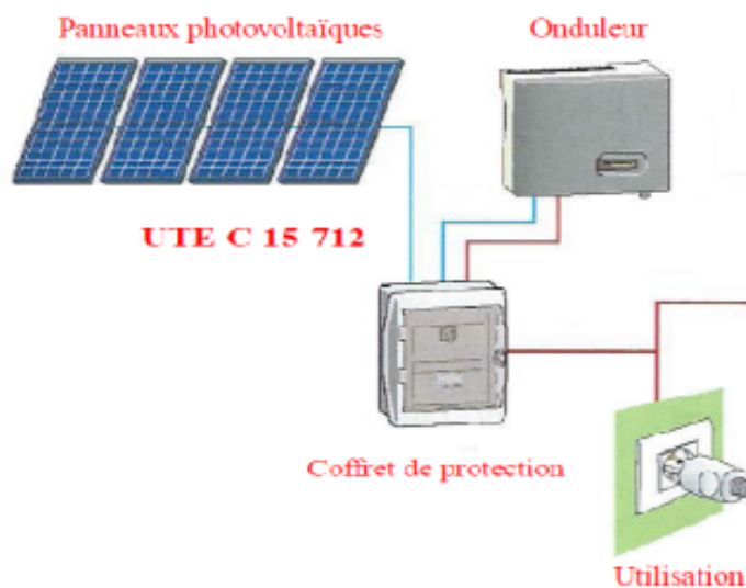
FIGURE I.21 – Système photovoltaïque connecté à un onduleur
