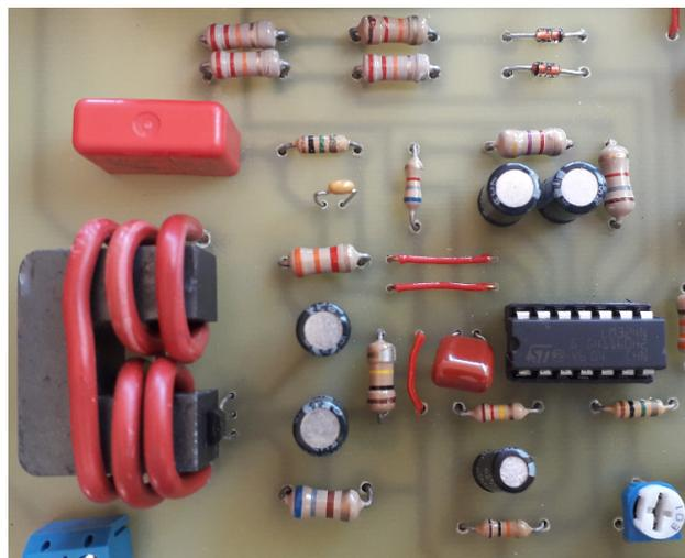
FIGURE 3.11 – Bloc comparateur et capteur sous PCB
