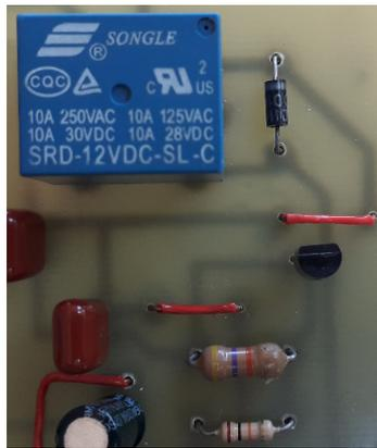
FIGURE 3.19 – Bloc qui commande de relais sous PCB
