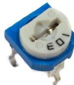
FIGURE 2.19 – Présentation d'un potentiomètre
