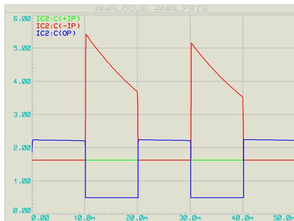
FIGURE 3.13 – Représentation des tensions d'entrée et de sortie du comparateur IC2/C
