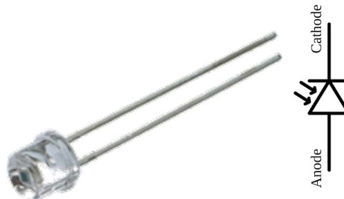
FIGURE 1.11 – Image et symbole d'une photodiode
