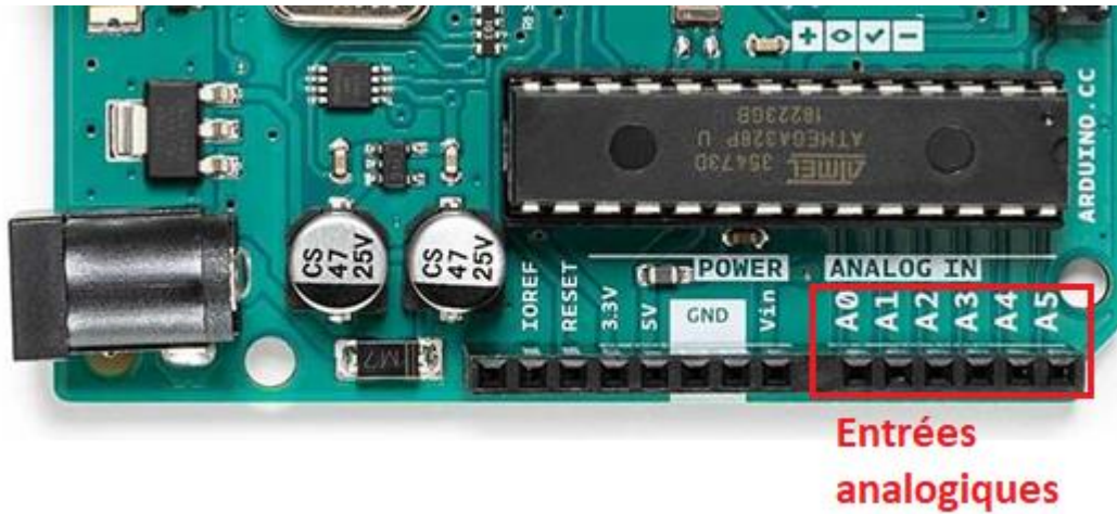
Figure 2.11 Broches d'entrées sorties analogique de l'Arduino.
