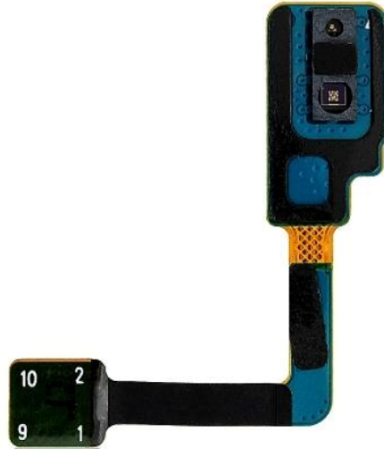
Figure 2.32 Capteur de proximité d'un téléphone portable.
