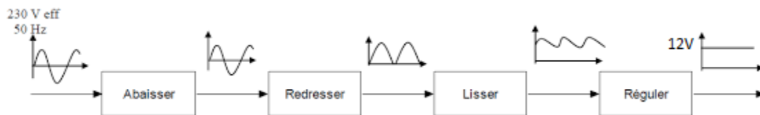
Figure 2.14 Principe d'une alimentation stabilisée.
