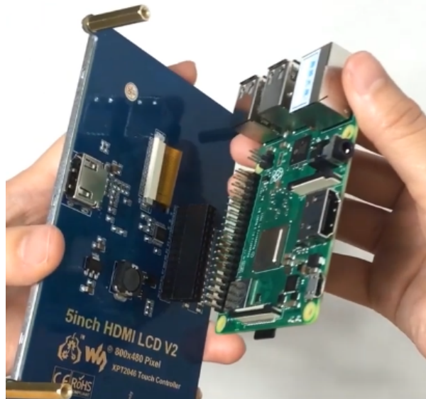
FIGURE 4.3.12 – Connection de l'écran avec les broches GPIOs.
