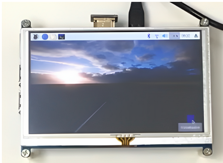
FIGURE 4.3.14 – L'écran LCD avec la RPi alimenté par une alimentation 5V.
