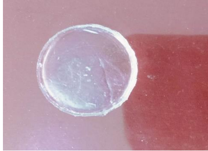
Figure II.8 : Pastilles obtenues après 30 minutes de polymérisation.
