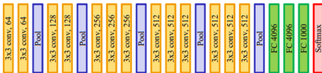
Figure II.14 : L'architecture du VGG 16 ;
