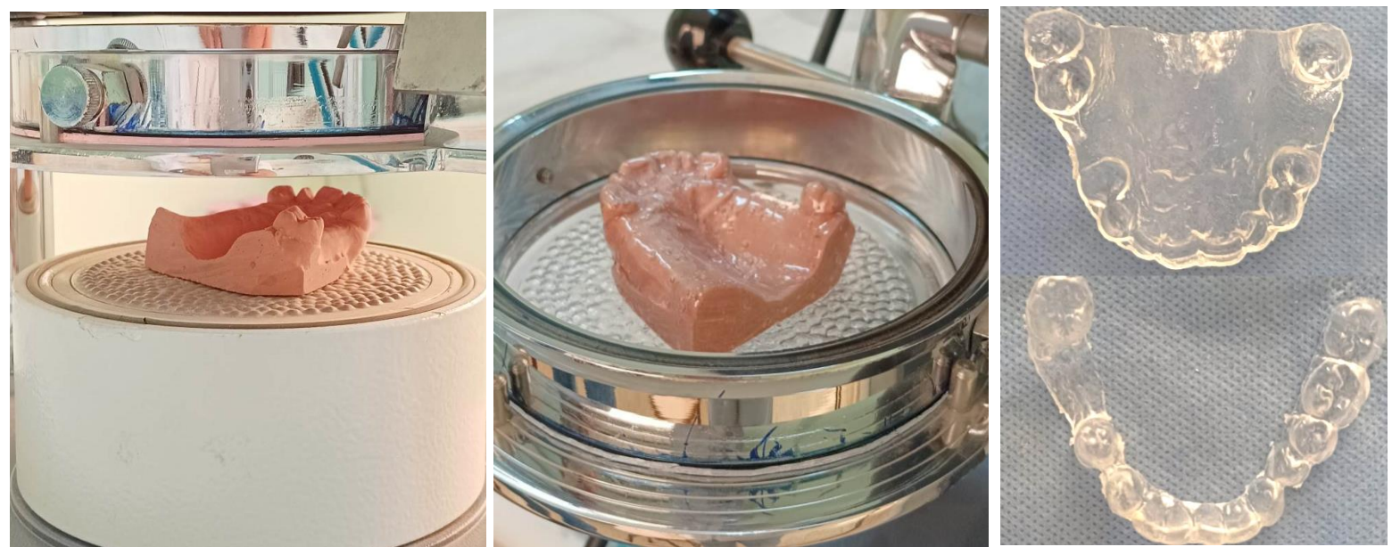
Figure 39: la confection des orthèses au laboratoire par la pompe à vide
