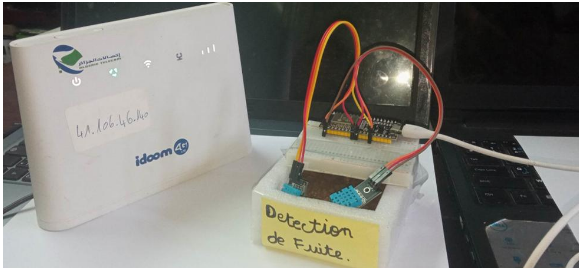
Figure IV-19: Prototype de détection de fuites
