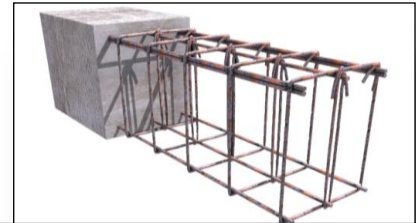
Fig88 : poutre en béton armé
