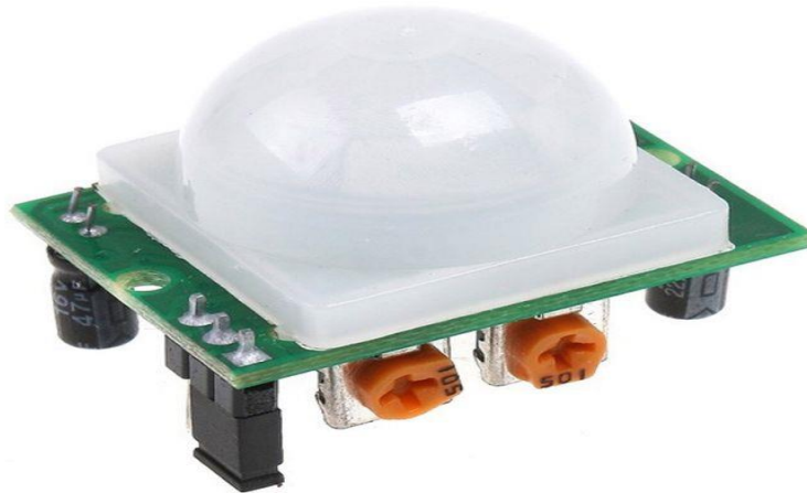
Figure8 : Capteur de mouvement PIR - HC-SR501
