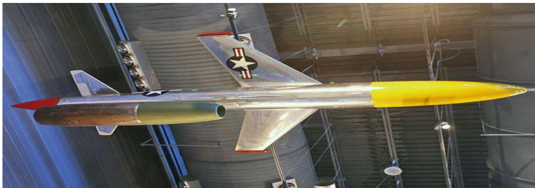
Figure II.16: Moteur statoréacteur positionné sous le missile Gorgon IV
