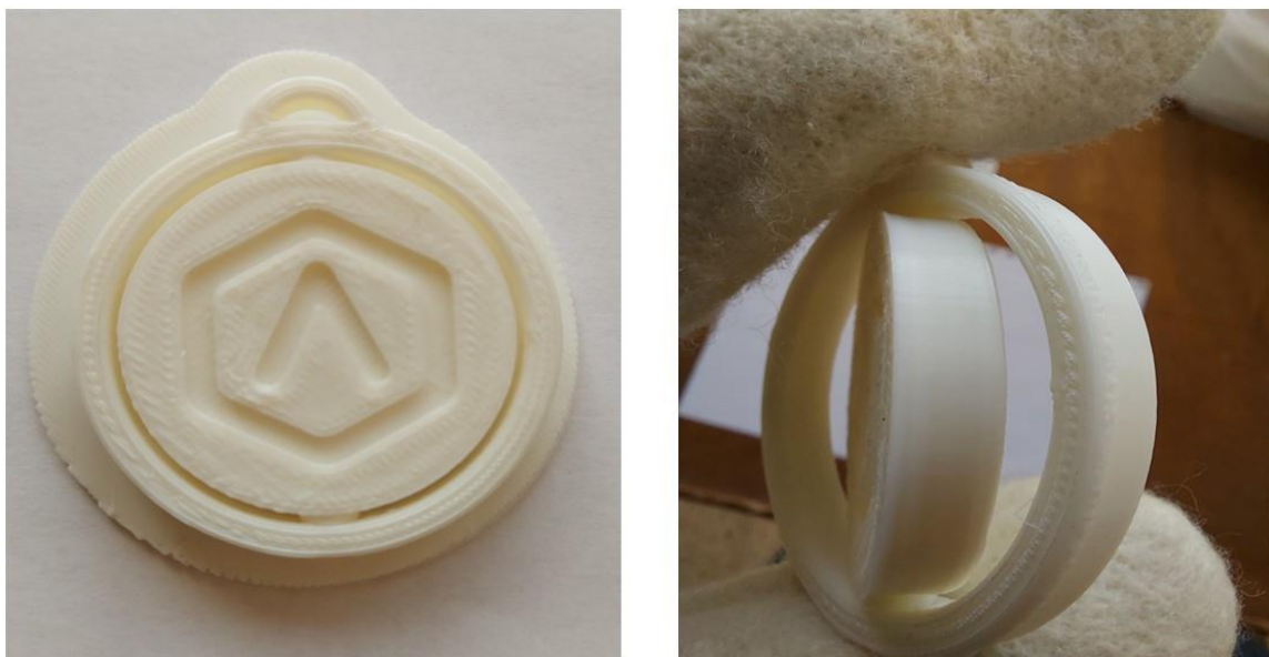
Figure III.24 Résultat d'impression réelle de «Giveaway Spinner» avec le profil «High Quality» sur Cura
