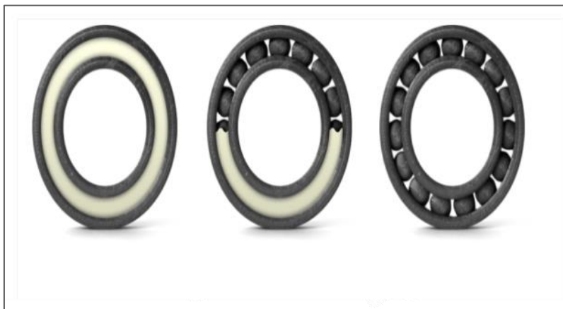
Figure I.14 Dissolution du matériau de support avec le D-Limonène [41]
