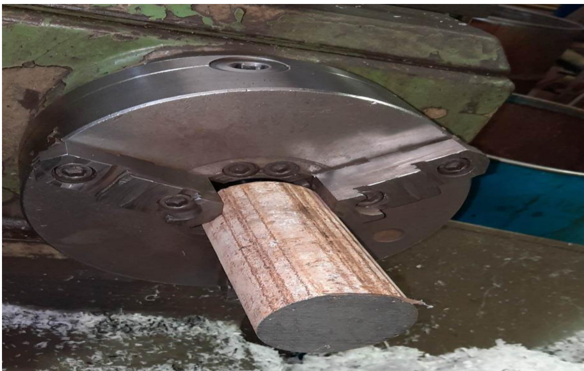
Figure 5. 4 : Montage de la pièce brute
