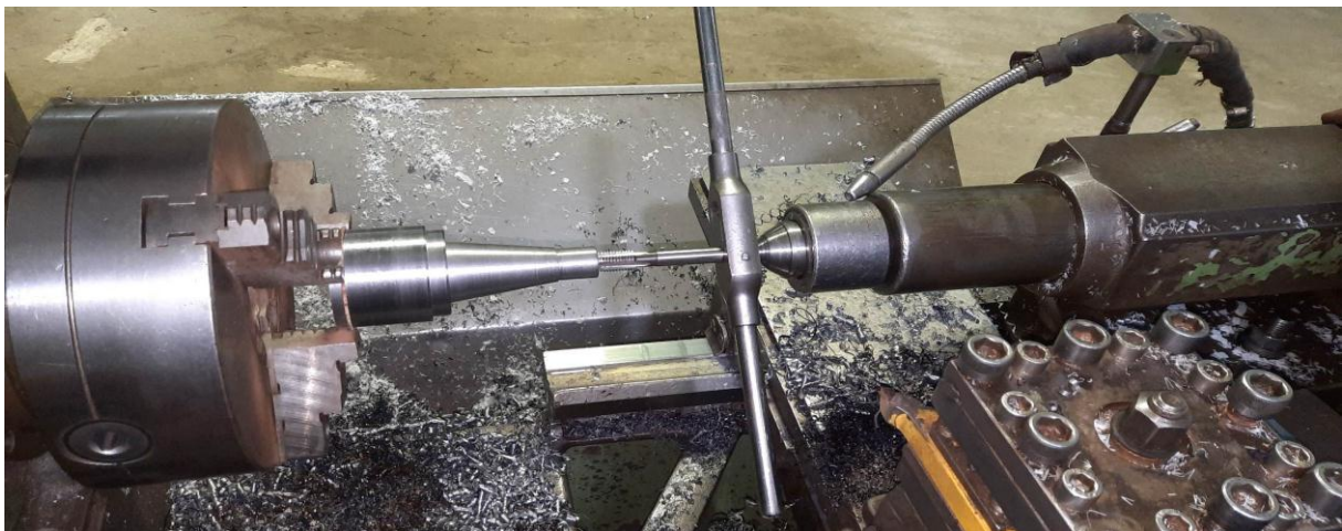
Figure 5. 12 : perçage et taraudage
