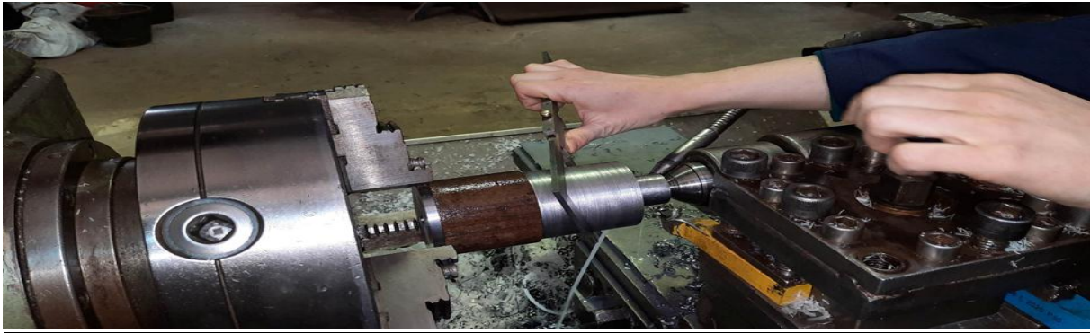
Figure 5. 7 : chariotage et contrôle
