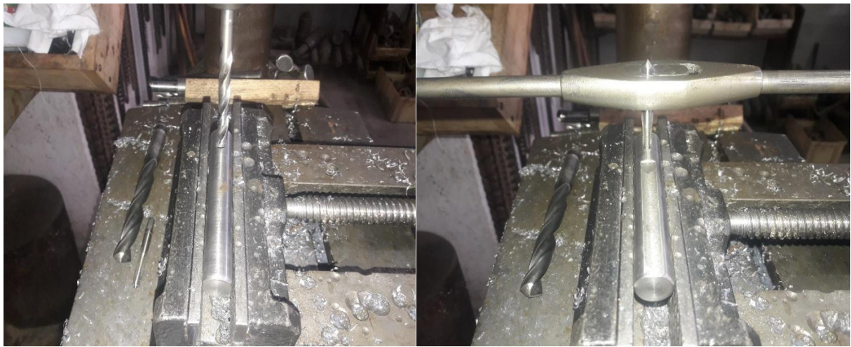
Figure 5. 19 : Opérations de perçage et taraudage.
