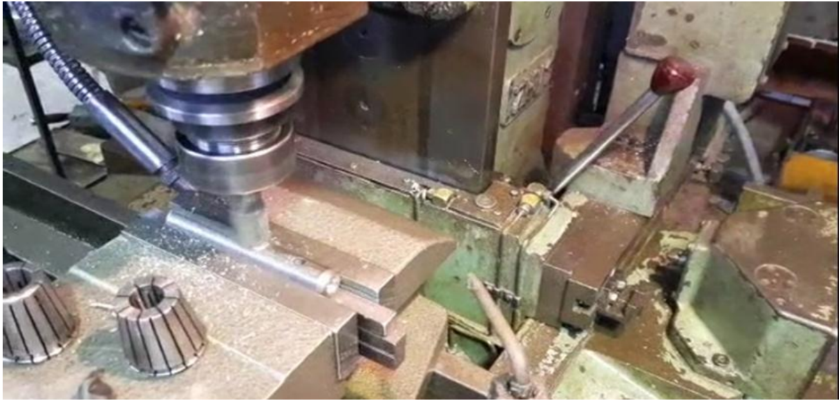
Figure 5. 18 : Méplat sur surface du porte outil
