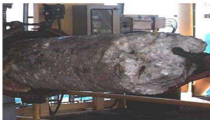
Figure III.4: Accumulation des hydrates obtenue après raclage de la conduite lors d'un entretien périodique (source Petrobras, Brasil) [10].
