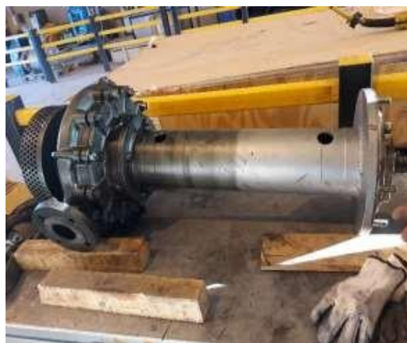
Figure III.22. Pompe à huile de lubrification.
