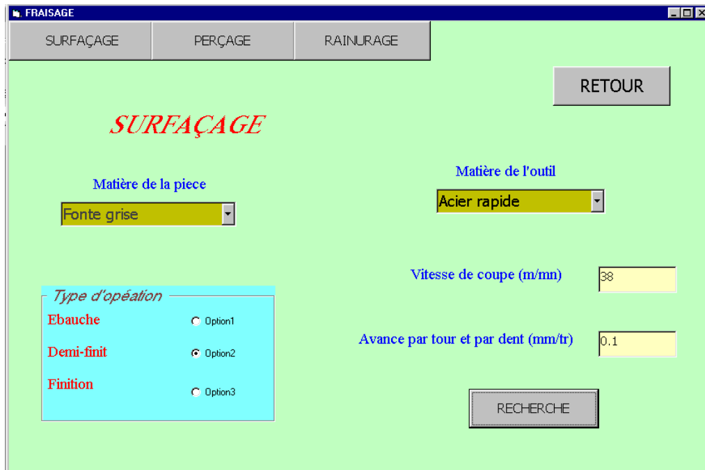
Figure 3-31: Aide au choix des paramètres de coupe dans le cas de SARFAÇAGE.
