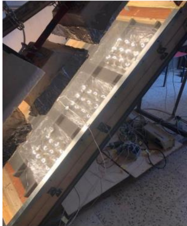
Figure.III.19. Expérience d'un absorbeur trapézoïdale à 16 cm de distance entre le vitrage et la source
