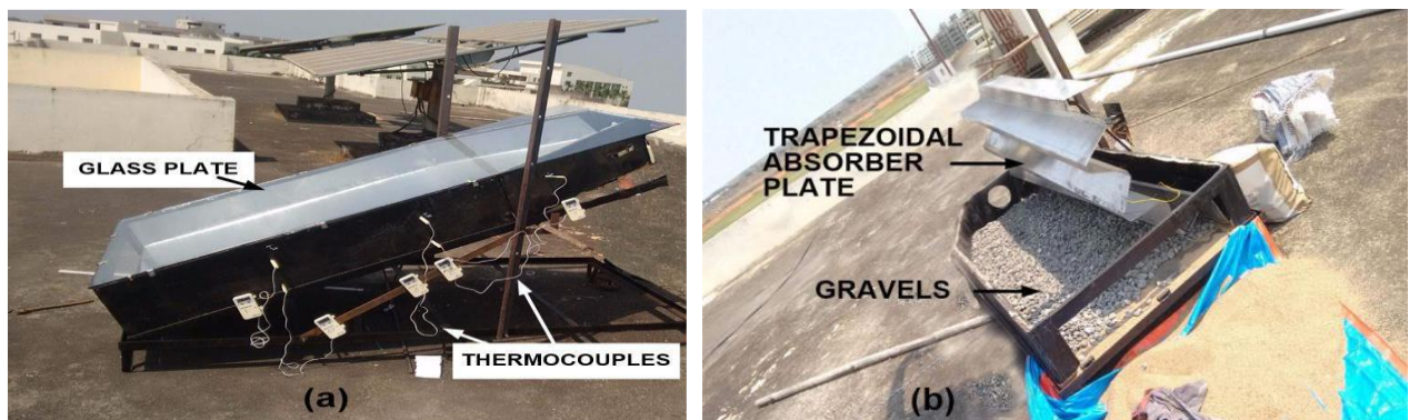
Figure.I.5. Montage expérimental (a) monté avec des thermocouples (b) Plaque absorbante trapézoïdale et graviers
