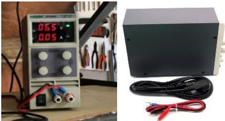
Figure.III.24. Contrôleur de tension et d'ampérage (WANPTEK KPS3010D)
