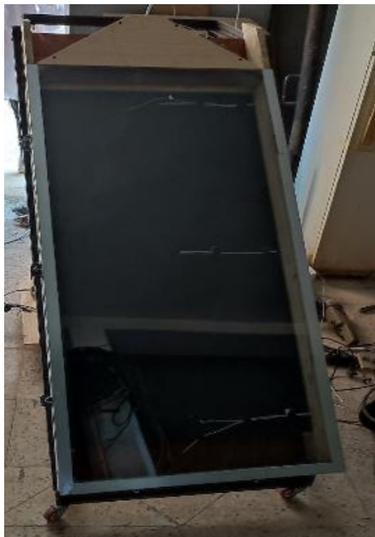
Figure.III.2a. Capteur solaire à air avec absorbeur plat de dimensions 1.20 \times 0.635
