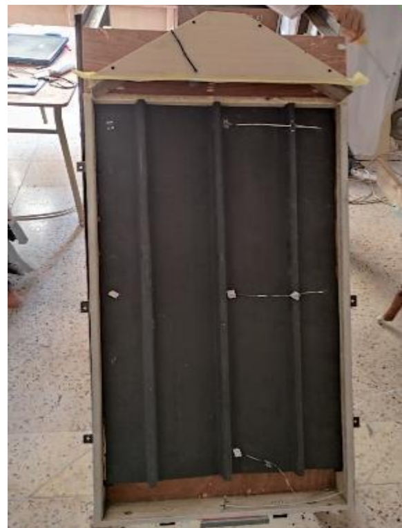
Figure. III.2b. Capteur solaire à air avec absorbeur trapézoïdal de dimensions 1.20 \times 0.7696
