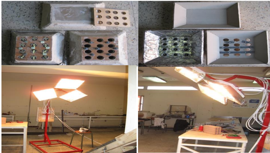
Figure.III.16. Représentation de montage de source thermique
