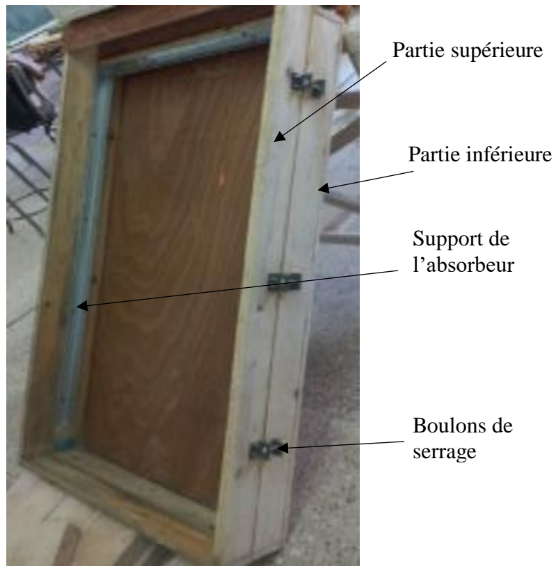
Figure. III.1. Vue générale du capteur solaire à air durant la conception
