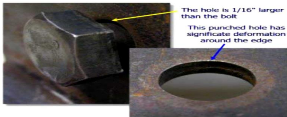
Figure II- 15:Ovalisation du trou lors du glissement de la pièce
