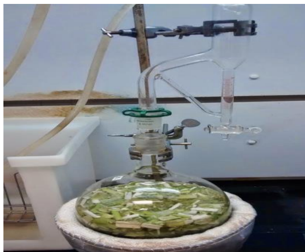
Figure 7 : L'appareil d'extraction des huiles essentielles par hydrodistillation « Clevenger »
