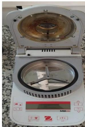
**Figure 10** : Appareil de mesure d'extrait sec total (**Original**).
