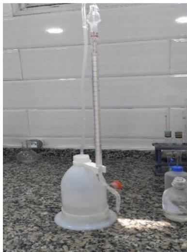
**Figure 09 : Mesure de l'acidité (original).**
