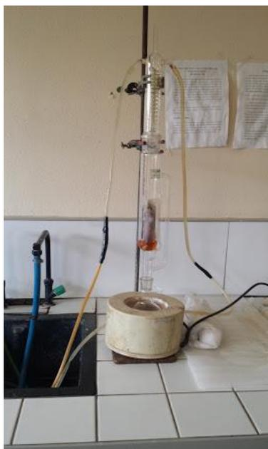
**Figure photographique 07 :** le montage d'un extracteur de Soxhlet.
