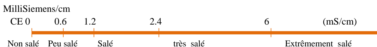
Fig. 10: Echelle de salure en fonction de la conductivité de l'extrait aqueux au 1/5.
