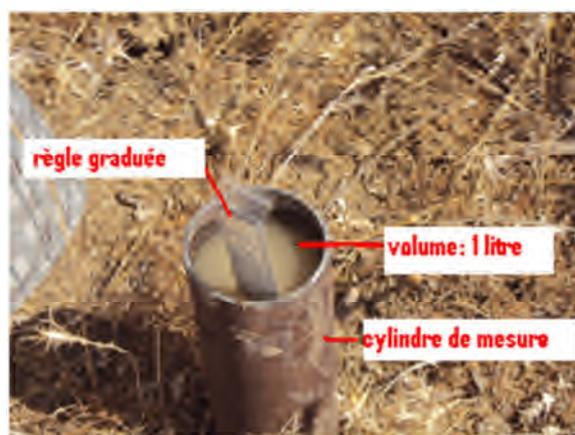
**Figure n°23** : test d'infiltration au monocylindre ; matériel facile à transporter nécessitant une faible quantité d'eau par rapport aux simulateurs de pluie
