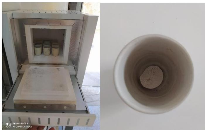
**Figure 35.** Détermination du taux des cendres dans un four à moufle.
