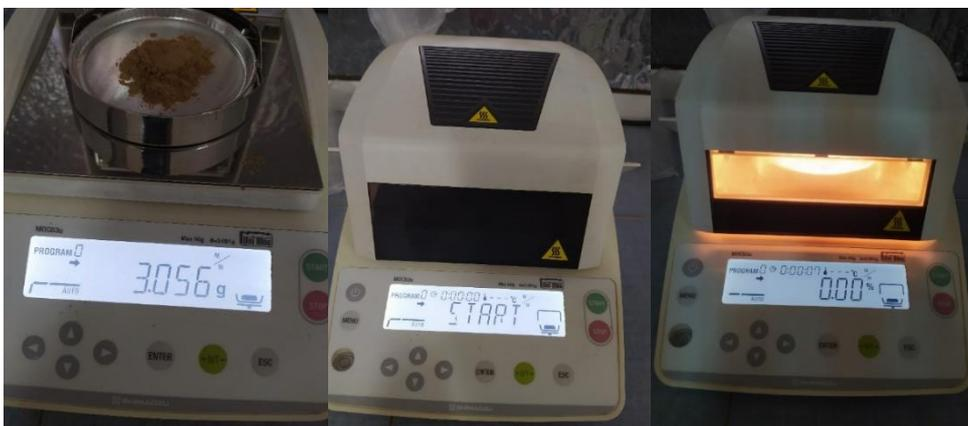
Figure 34. Etapes de mesure de l'humidité d'un échantillon dans une balance thermique.
