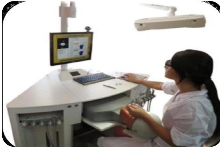
Figure 11: Unité de formation avec Dentsim® (camera de repérage en haut à droite) [1, 19]
