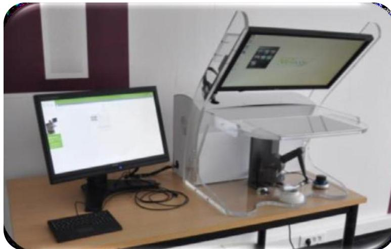
**Figure 18** Le dispositif haptique Geomagic Touch X (anciennement phantom desktop® de chez sensible) utilisé pour le Virteasy®<sup>[1]</sup>
