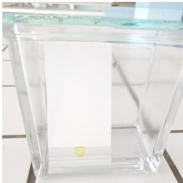
**Figure 39:** Plaque placée dans la cuve.
