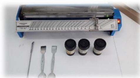
Figure 44: Détermination du point de fusion à l'aide d'un Banc Kofler
