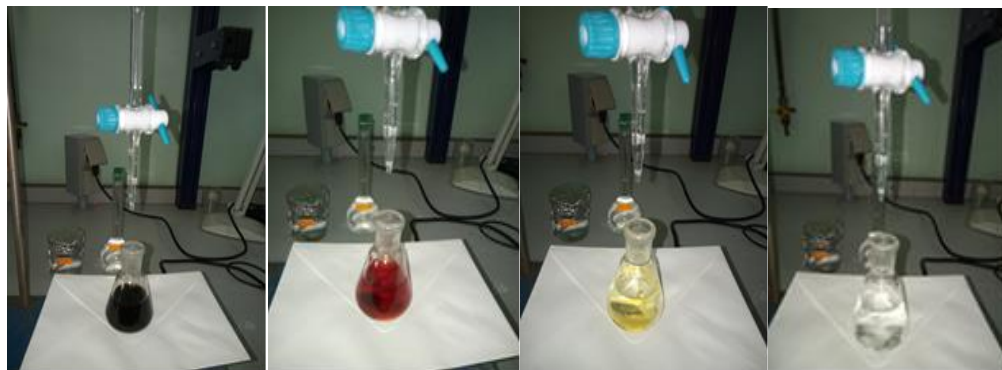
Figure 9: Les étapes du dosage de PVP-I par thiosulfate de sodium
