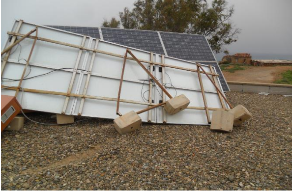
Figure 2.1 : Mauvaise résistance mécanique des supports des modules
