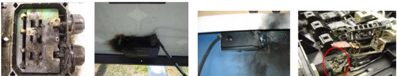
Figure 2.12 Exemples de défauts rencontrés dans des boîtes de jonction
