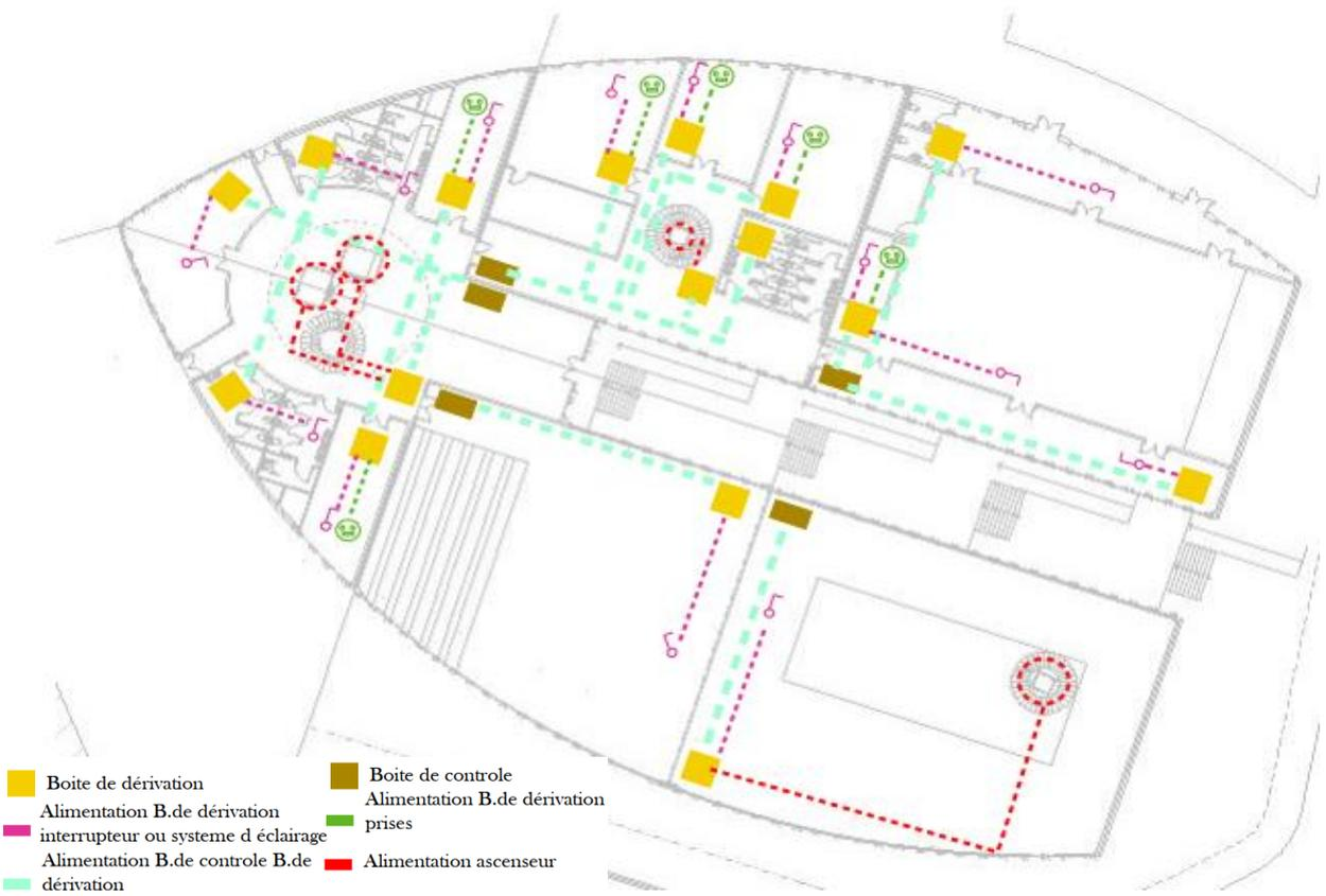
**Figure 101** coupe et plan réseau courant fort (source : auteure)
