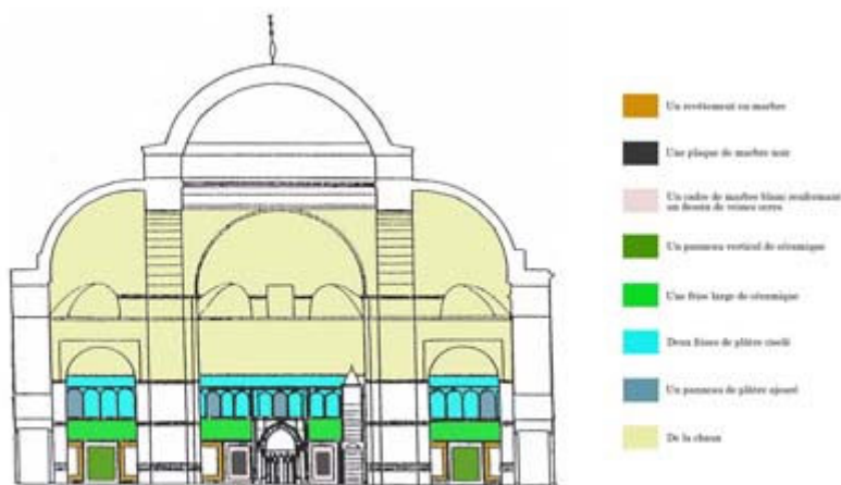
Planche 5 : Les différents registres décoratifs du mur de la qibla de la salle de prières Source : Photographie de l'INP de Tunisie
