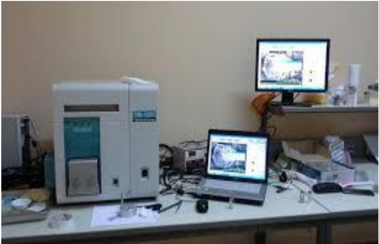
Figure 9: Microscope électronique à balayage Hitachi TM1000.
