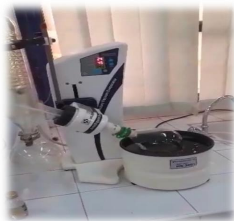
Figure 10 : Evaporation des feuilles d'olivier au rotavapeur
