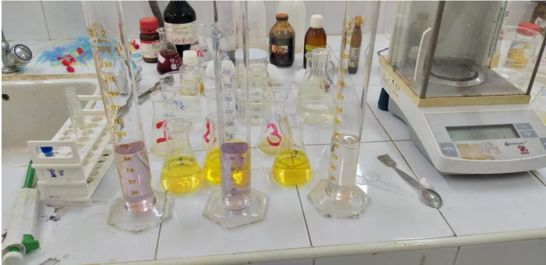
Photo24 : Résultat titrage colorimétrique pour la détection de l'activité amylasique.
