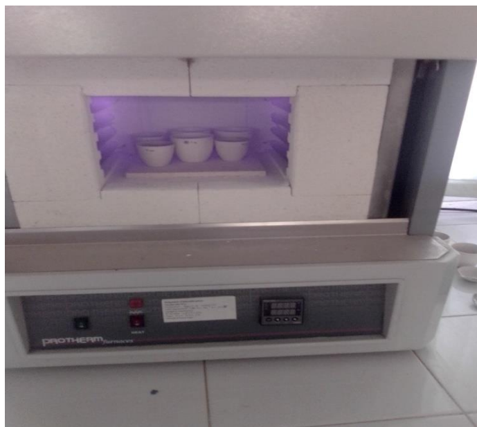
Photo18 : Incinération des échantillons dans un four d'incinération (Originale, 2022)
