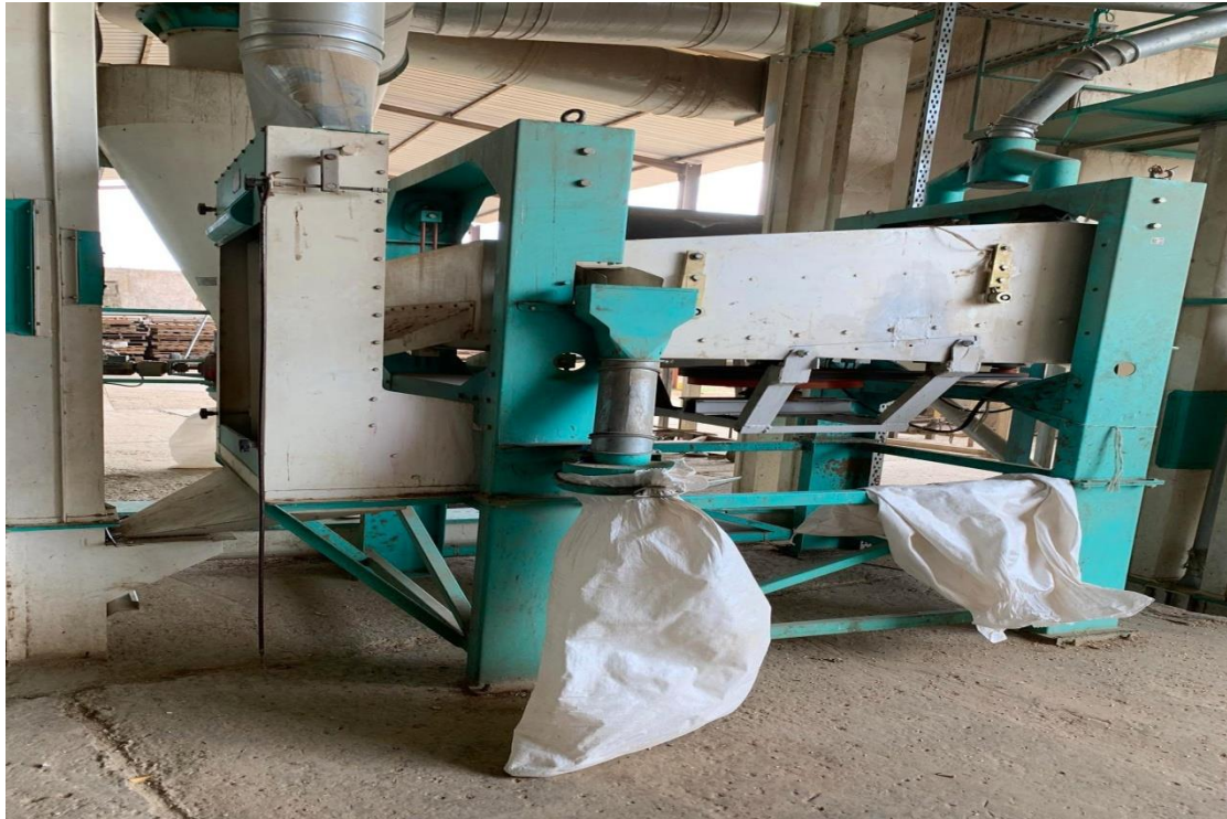
Figure 10 : Machine Nettoyeur Séparateur CCLS Ouled Mimoun (2021).
