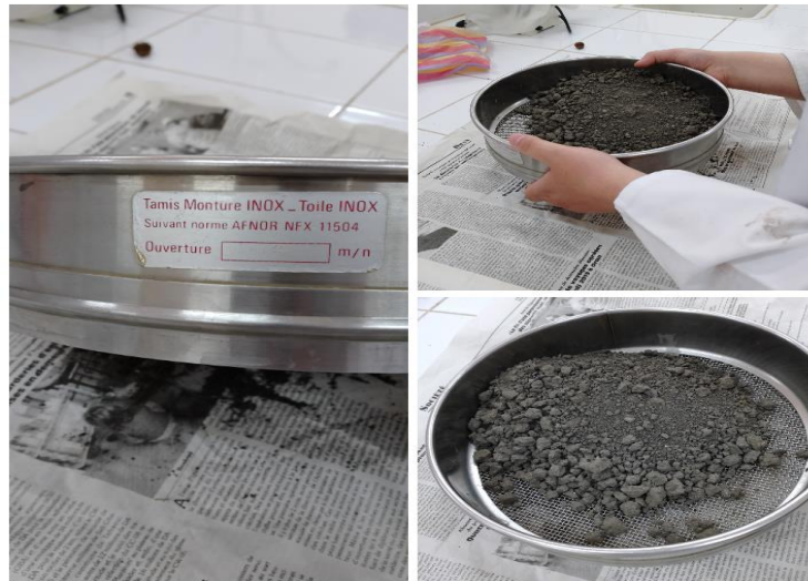
Photo N°3 : tamisage d'un échantillon de sol à l'aide d'un tamis à trous de 2mm
