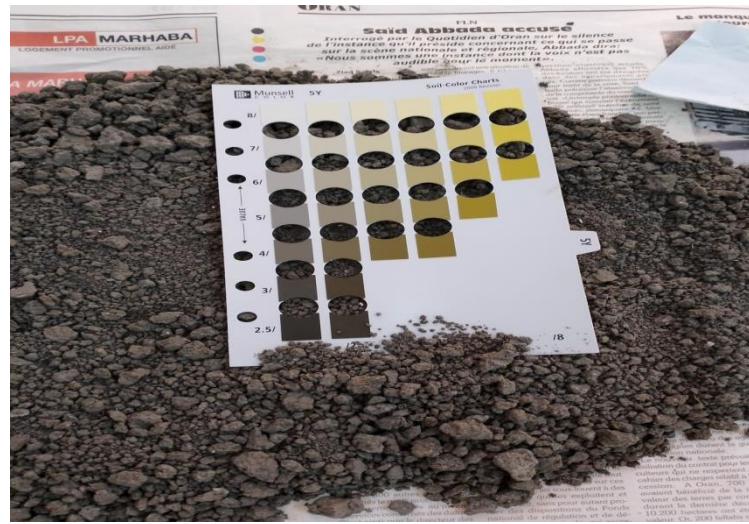
Photo N°2 : identification de la couleur du sol à l'aide de (Munsel soil color book)
