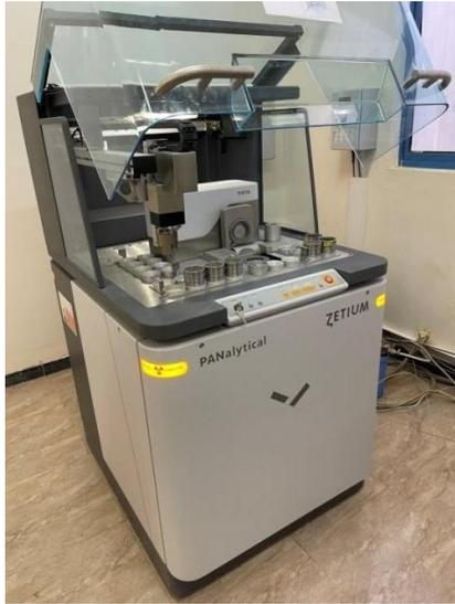
Fig. 08 : Spectroscopie fluorescence X.
