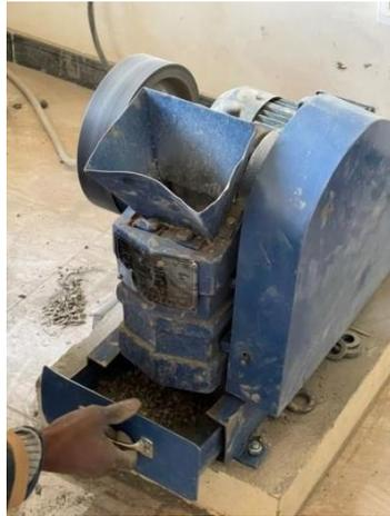
Fig. 06 : Broyeur électrique.
