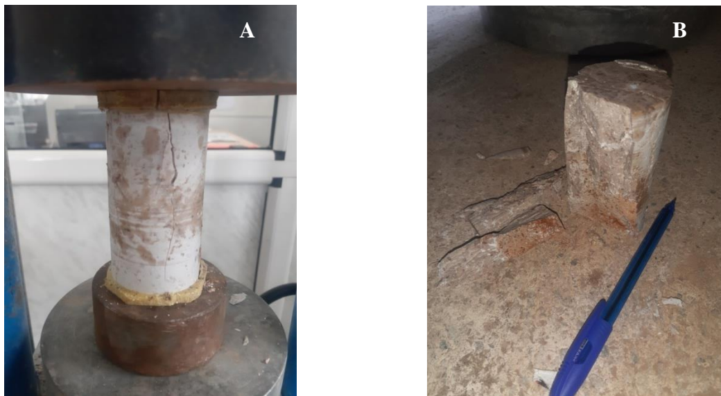
Figure 20 : Essai pétrophysique d'un échantillon de calcaire A- Avant l'application de la force B- Après l'application de la force
