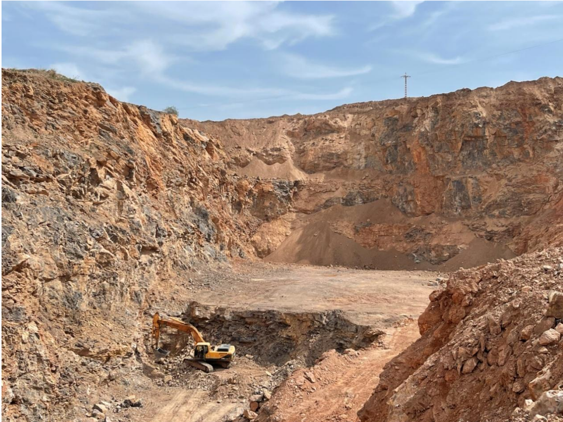
Fig. 15: Vue panoramique montant les cinq gradins formant le front de taille principale de la carrière.
