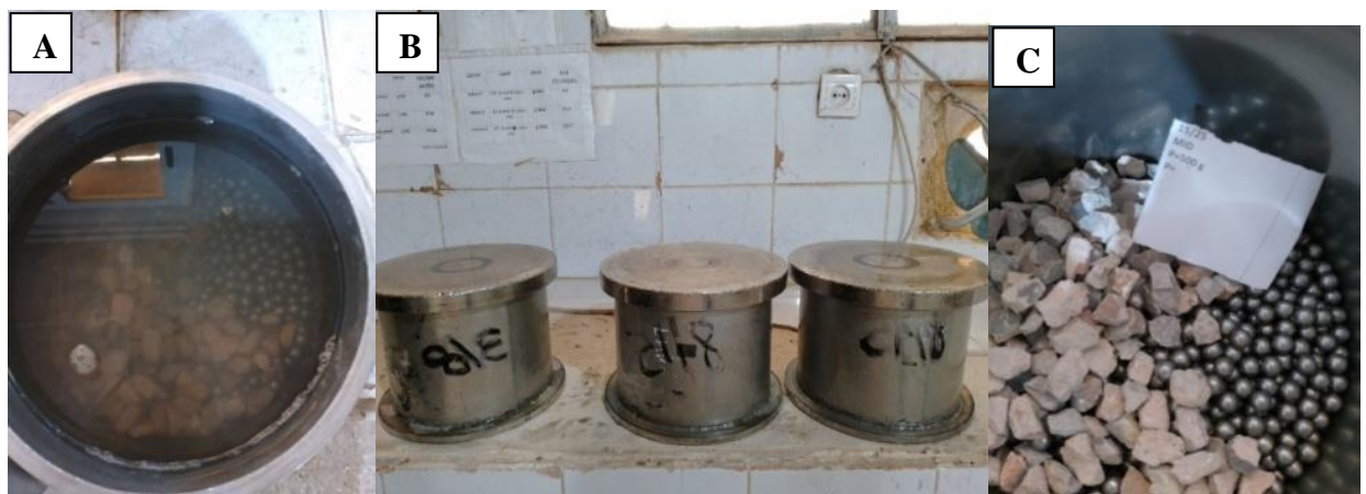
Fig. 11: Différentes étapes d'essai Micro Deval (A) Préparation de l'échantillon; (B) les 3 échantillons sont prit pour l'opération; (C) l'échantillon après l'opération.
