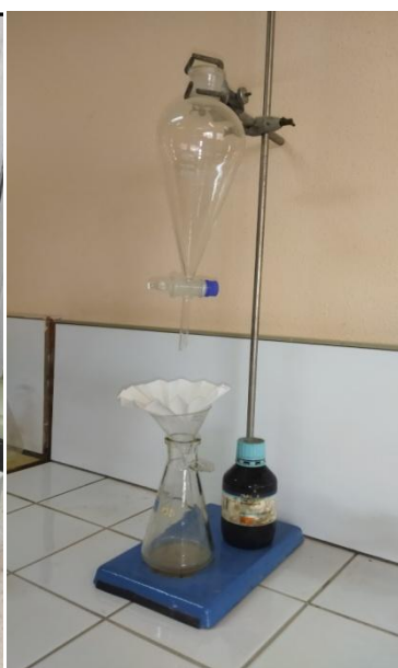
Dispositif de séparation densimétrique
