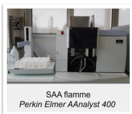
Figure 15: spectroscopie d'absorption atomique flamme
