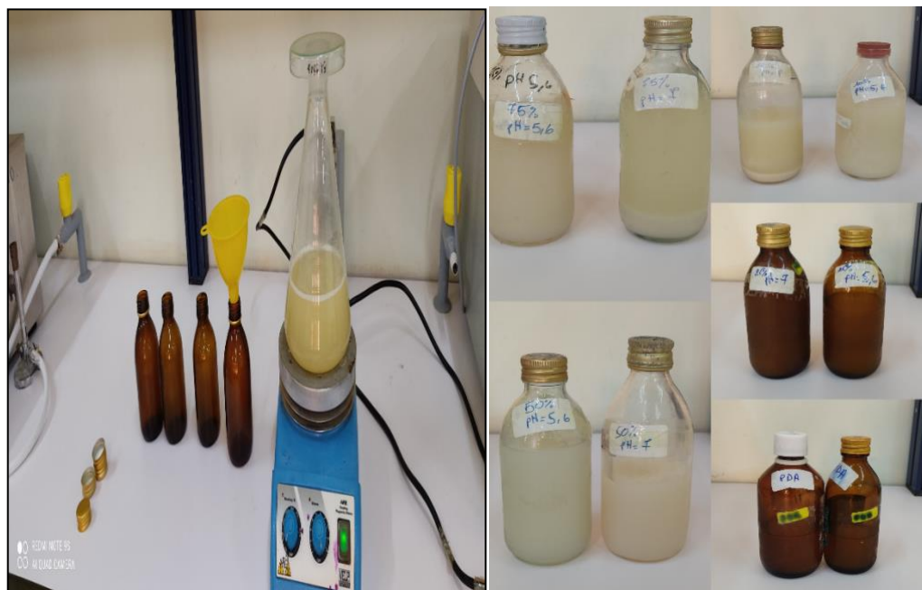
Figure 13:Remplissage des flacons avec du lactosérum à différentes dilutions et à différents pH (originale)
