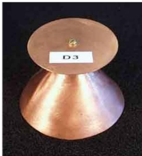
Figure II.10 : Exemple de réalisation d'une antenne discône.
