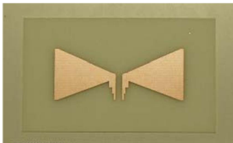
Figure II.11 : Exemple de réalisation d'une antenne papillon.
