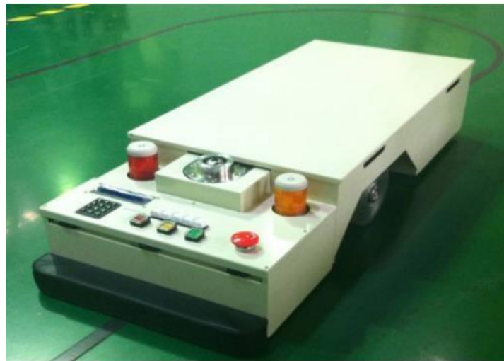
Figure I. 9 : Un AGV suivant une bande magnétique (Ecvv.com, 2017) [8]
