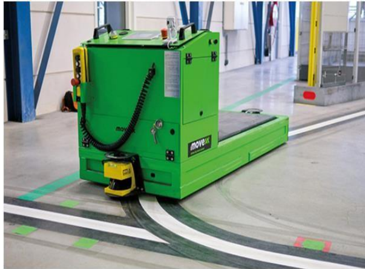
Figure I. 6 : L'AGV utilise un guidage optique pour suivre sa trajectoire, et des étiquettes RFID pour gérer des situations plus complexes (Turck.de,2017) [8]
