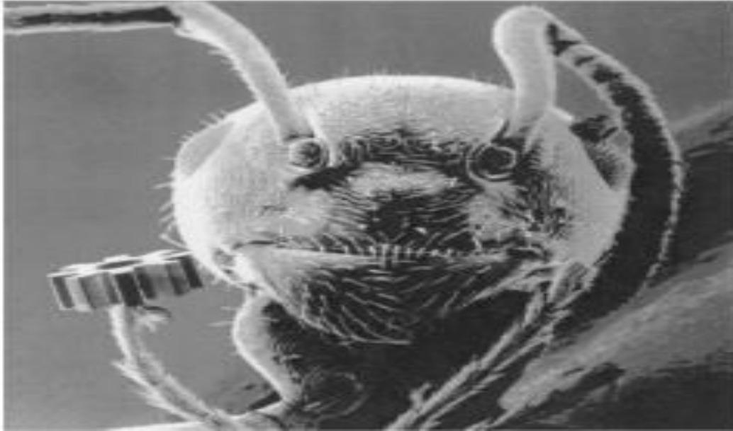
Figure 1.4. Fourmi tenant un micro-engrenage en nickel fabriqué par la technologie LIGA [16].
