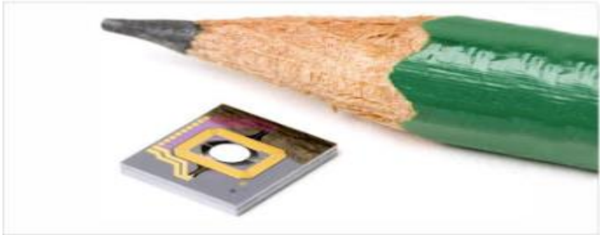
Figure 1.6. Visualisation de l'échelle d'un MEMS [20].
