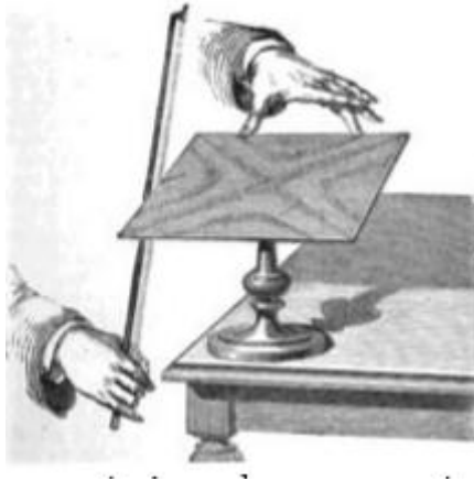
Figure 3.1 :création des figures de Chladni d'une plaque libre[12]
