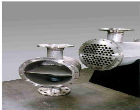
Intérieur d'un échangeur tubulaire
