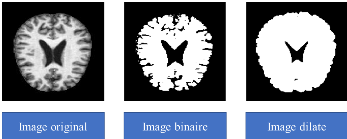
Figure II.3 : Exemple de dilations sur des images binaires.
