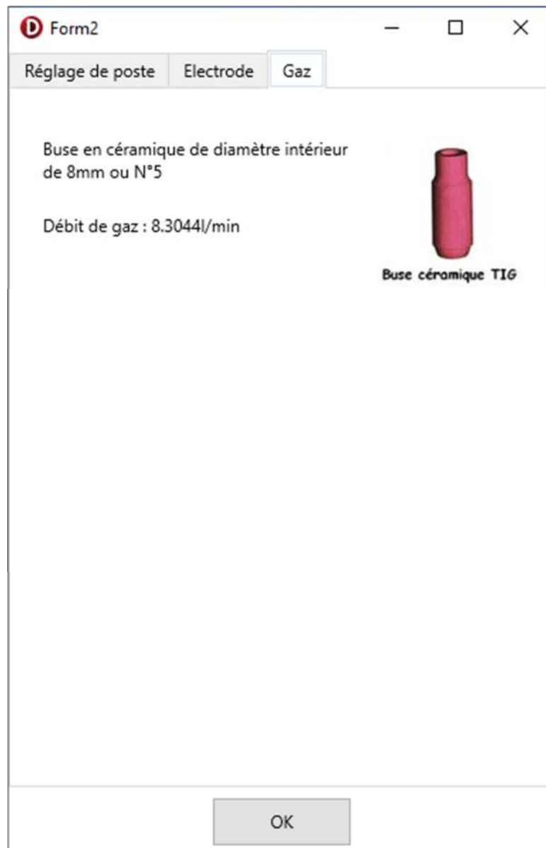
Figure 3-20 : qualité de buse utilisé
