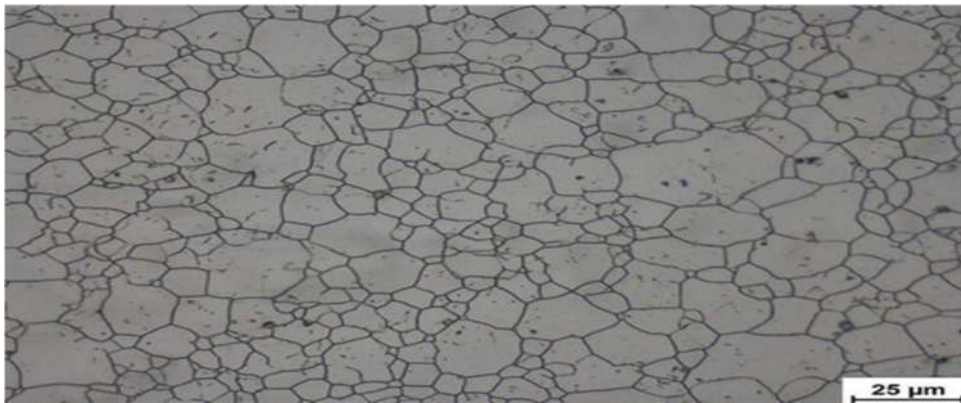
Figure 1- 6: Micrographie d'un acier inoxydable austénitique
