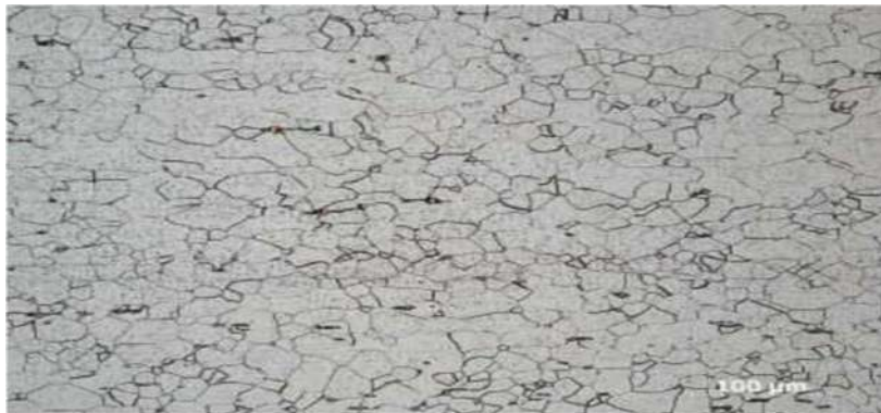
Figure 1- 4: Micrographie d'un acier inoxydable ferritiques.
