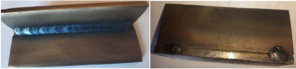
Figure 3-12 : cordon de soudure de deux plaques d'inox soudée par TIG
